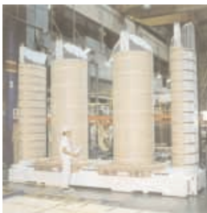
Montagem do núcleo e enrolamentos: parte ativa completa de um transformador de 135 MVA com comutador em carga.
