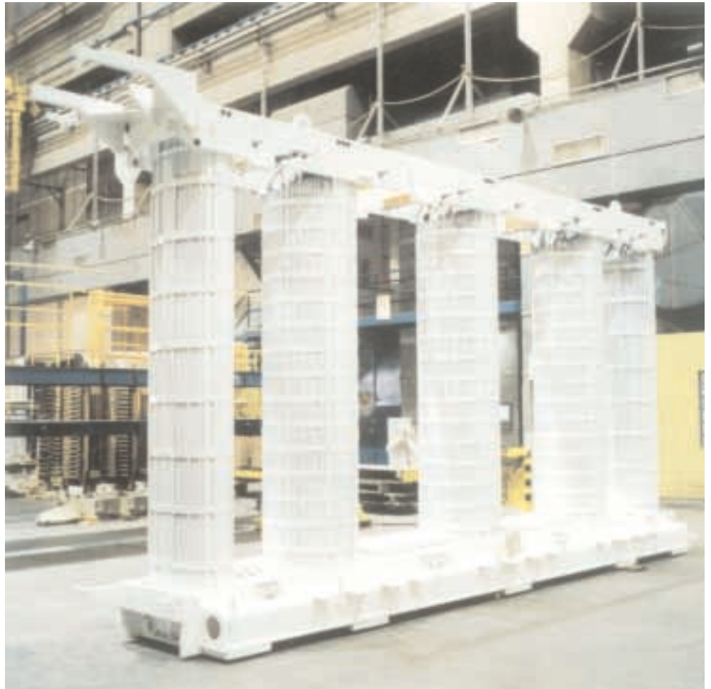
Núcleo de um transformador de 135 MVA em construção especial para baixo nível de ruído de 55 dB.
