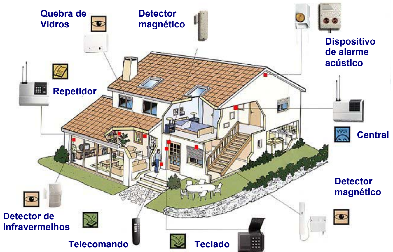
Fig.2 – Sistema de intrusão
